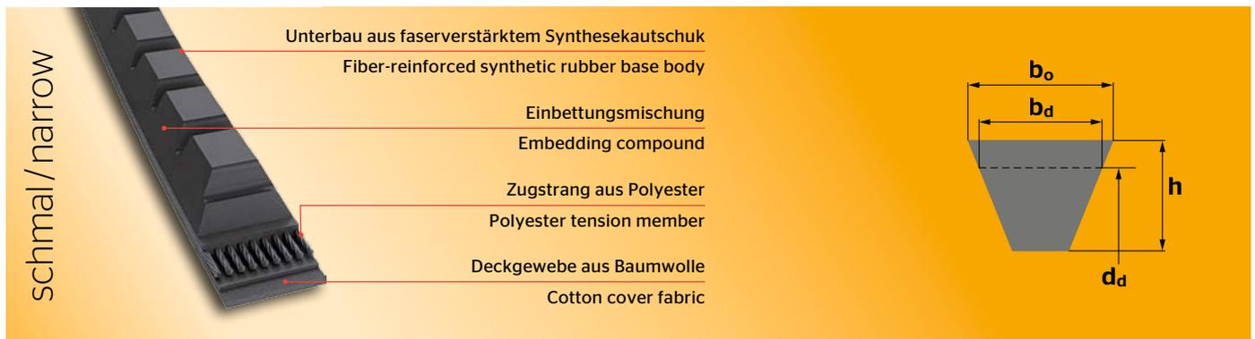
Der CONTI-V® FO ADVANCE kann nahezu jeden Antrieb ersetzen, der mit ummantelten Keilriemen ausgestattet ist. Typische Einsatzgebiete sind Kompressoren, Baumaschinen, Powercutter, Abluftventilatoren und Pumpen in der Ölindustrie. Der Keilriemen ist besonders langlebig und überzeugt durch verringerte Systemkosten von bis zu 50 % im Vergleich zu ummantelten Schmalkeilriemen. Seine optimierten Flanken sorgen für ein sehr ruhiges Laufverhalten und reduzieren dadurch Schwingungen.
