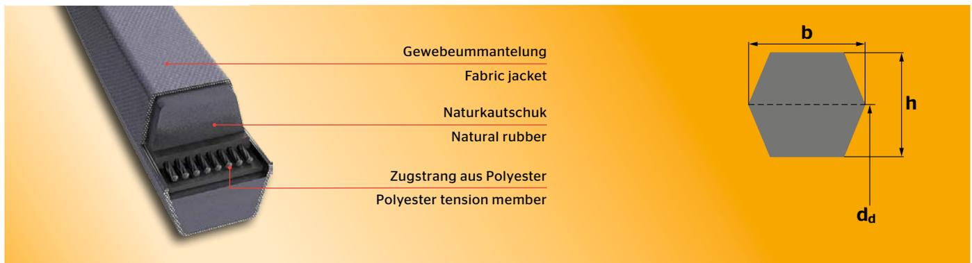
Der CONTI-V® DUAL wurde für den Betrieb von Gegenlaufantrieben im gesamten Maschinenbau entwickelt. Das doppelte Keilprofil des Riemens macht ihn für Antriebe mit wechselseitiger Biegung, bei denen beide Seiten des Riemens zur Leistungsübertragung benutzt werden sollen, besonders geeignet. Typische Einsatzgebiete finden sich bei Gartengeräten und in der Landwirtschaft, aber auch z. B. bei Mühlenantrieben.
