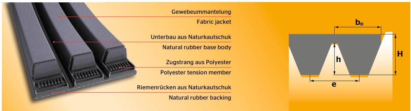
Der CONTI-V® MULTIBELT wird typischerweise bei großen Achsabständen und in staubigen Umgebungen, z. B. bei Steinbrechern und Asphaltfräsen, eingesetzt. Gut eignet er sich auch für landwirtschaftliche Anwendungen. Die quersteife Deckplatte verhindert Verdrillen und übermäßiges Schwingen einzelner Riemen.
